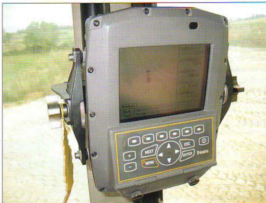
■ Il sistema GPS SiteVision EXC per escavatore, montato su un modello Zaxis di Hitachi. Dalla cabina è possibile controllare ogni operazione, confrontando le coordinate con il progetto esecutivo
