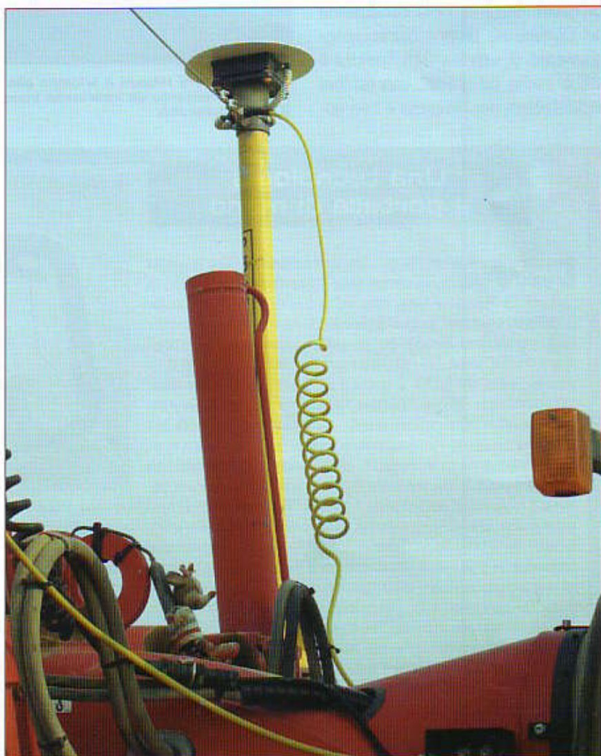
■ Una delle due antenne GPS montate sulla lama del grader D&K. La loro posizione è calcolata istante per istante dal ricevitore in cabina
